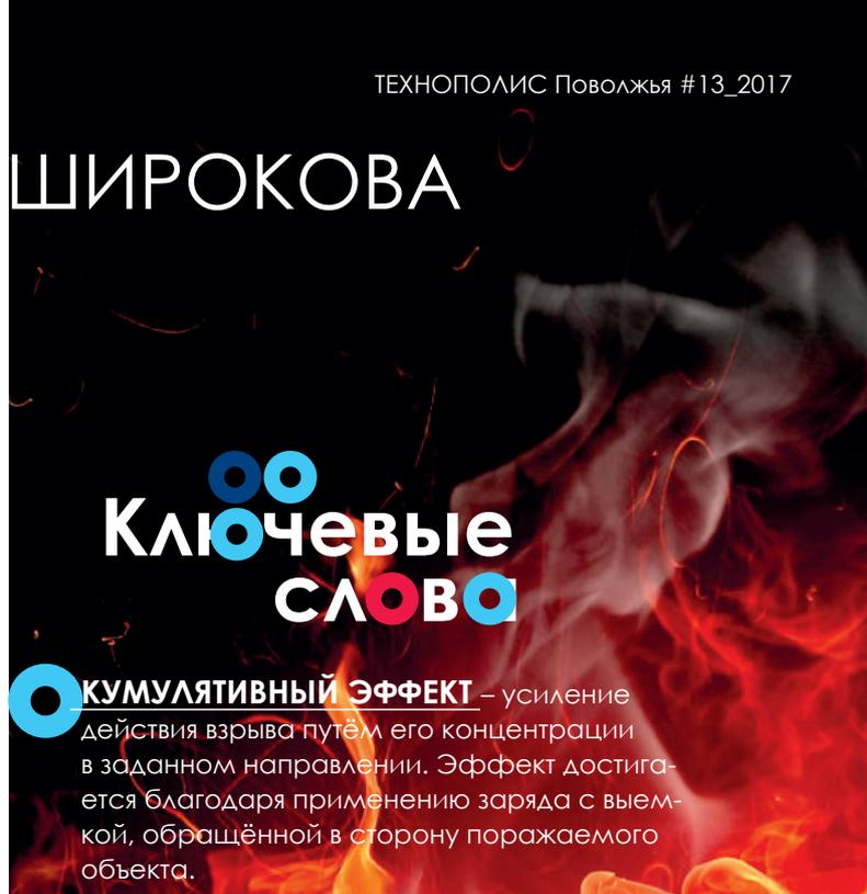
**КУМУЛЯТИВНЫЙ ЭФФЕКТ** – усиление действия взрыва путём его концентрации в заданном направлении. Эффект достигается благодаря применению заряда с выемкой, обращённой в сторону поражаемого объекта.
